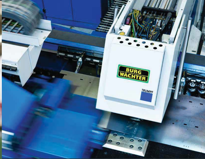
Pecíz: A legmodernebb gépeket használjuk a fontos munkafolyamatok precíz elvégzéséhez. Itt kiváló minőségű rozsdamentes acélból készült postaládáink alkatrészeit lyukasztják ki.
