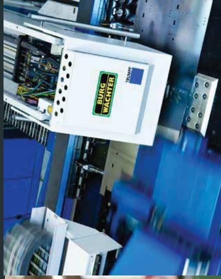
Präzise: Modernste Maschinen sind bei uns im Einsatz, um wichtige Arbeitsschritte ganz exakt durchzuführen. Hier werden Teile von hochwertigen Edelstahl-Briefkästen ausgestanzt.
